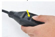
3. Drücken Sie die Test-Taste, die Anzeige erlischt.
